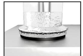
Dans le cas d'un conduit galvanisé, faites le glisser sur le collet, vissez en place et scellez le.
