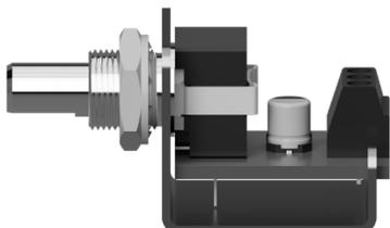
Le potentiomètre EC-10VHL est développé pour une doublure de hotte qui a besoin d'un signal de commande continu. La tension d'alimentation est comprise entre 10 et 12 VDC. La tension de sortie est ajustée en continu de 0 à la tension d'alimentation (Us) par un bouton rotatif.
