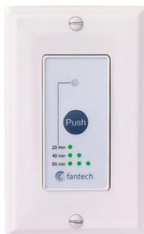
Le RTS5 est un interrupteur de minuterie à distance basse tension qui peut être utilisé pour activer l'appareil à air frais à son taux de ventilation le plus élevé pendant 20, 40 ou 60 minutes. Il est conçu pour tenir dans un boîtier électrique simple et est livré avec des vis pour y monter la commande ainsi qu'une plaque Decora<sup>MD</sup>. Les emplacements idéaux sont les salles de bains, les cuisines et les buanderies.
