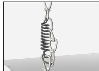
**4** Installez un ressort sur chaque chaîne. Accrochez le ressort de sorte qu'une boucle est créée dans la chaîne. Le ressort supportera le poids du AAF et absorbera les vibrations.
