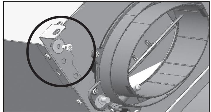
**4** Installez le support et remettre la vis et la rondelle. Répétez les étapes 3 et 4 de l'autre côté de l'appareil.
