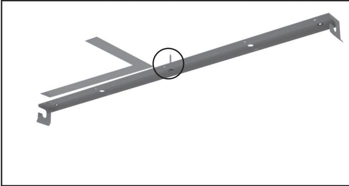
**1** Insérez la vis et la rondelle du milieu dans le support de montage à travers l'isolant en caoutchouc. Assurez le support est droit.
