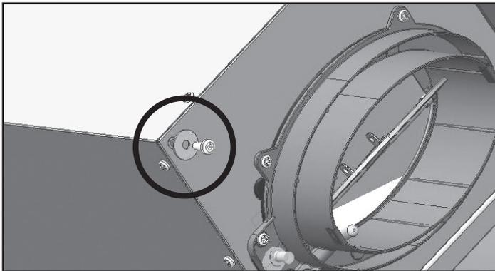
**3** Enlevez la vis et la rondelle de l'appareil pour placer le support.
