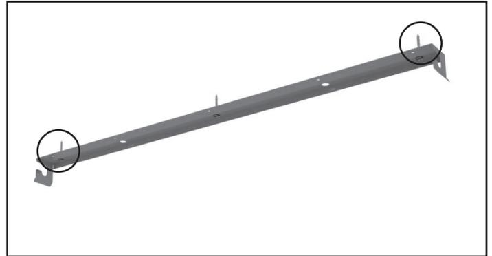
**2** Insérez les vis et rondelles des deux côtés du support pour fixer.
