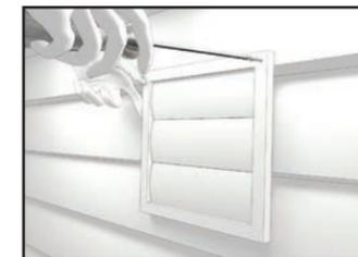
**3** Enfoncez la hotte dans l'ouverture. Fixez la hotte sur le mur extérieur en utilisant des vis de montage. Répétez la procédure d'installation pour la hotte d'aspiration et la hotte d'évacuation.
