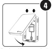
Fixez le module avant sur la plaque arrière, en insérant tout d'abord la partie supérieure du module avant dans les attaches supérieures, puis en pivotant le module en appuyant sur le bas, jusqu'à ce que vous entendiez un « clic ». Vérifiez que le système de ventilation fonctionne.
