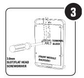
Insérez les fils de transmission (4) dans le bornier, situé sur la face arrière du module avant. Sécurisez-les en place en serrant les vis du bornier à l'aide d'un petit tournevis à tête plate de 3,0 mm (non fourni)
