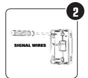
Guidez les deux (4) fils de commande dans l'ouverture centrale de la plaque de montage et montez cette dernière soit sur le boîtier d'un appareil électrique standard ou directement sur le mur à l'aide de vis. Au besoin, utilisez des dispositifs d'ancrage au mur.
