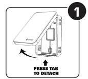
Détachez le module avant de la plaque de montage en appuyant sur la languette (situé en haut et en bas du boîtier de commande).
