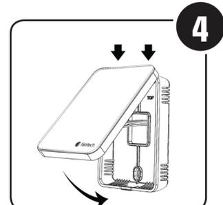
Fixez le module avant sur la plaque arrière, en insérant tout d'abord la partie supérieure du module avant dans les attaches supérieures, puis en pivotant le module en appuyant sur le bas, jusqu'à ce que vous entendiez un « clic ». Vérifiez que le système de ventilation fonctionne.
