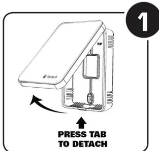
Détachez le module avant de la plaque de montage en appuyant sur la languette (situé en haut et en bas du boîtier de commande).
