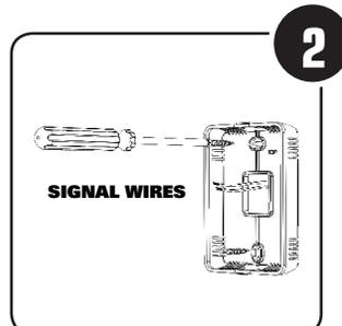
Guidez les deux (4) fils de commande dans l'ouverture centrale de la plaque de montage et montez cette dernière soit sur le boîtier d'un appareil électrique standard ou directement sur le mur à l'aide de vis. Au besoin, utilisez des dispositifs d'ancrage au mur.
